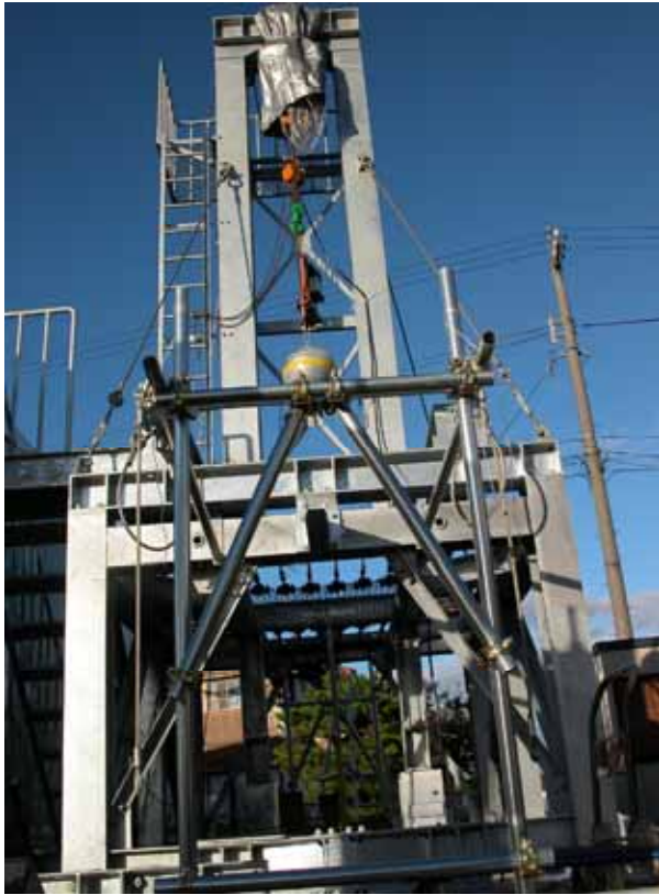
写真 3 金網の面外衝撃試験
