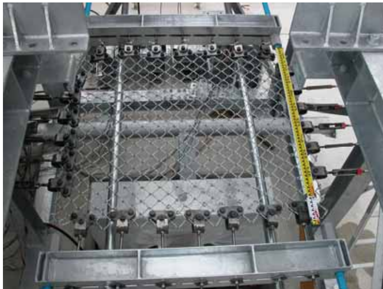
写真 1 金網の引張試験
