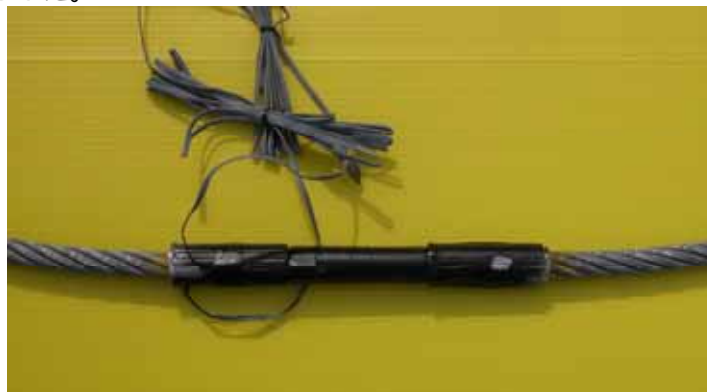
写真 9 ワイヤロープ張力測定用ストレインゲージの貼付状態
