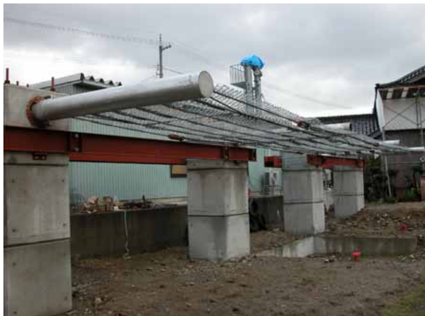
写真 6 実物実験用防護柵
